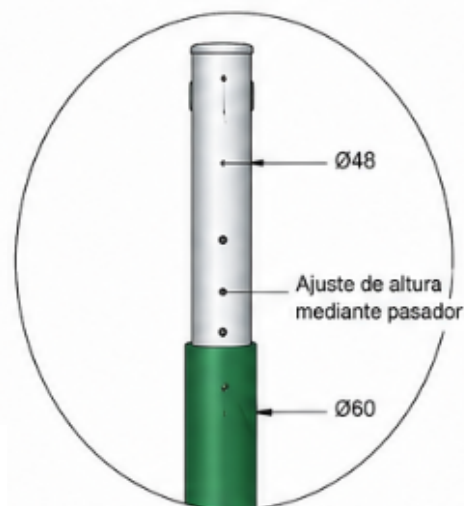
DETALLE PARTE SUPERIOR POSTE TELESCÓPICO
